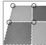
**9.** Для соединения модулей следует надавливая пальцем соединить угловые элементы замков соседних модулей, затем ударами **резиновой киянки** состыковать остальные элементы, продвигаясь вдоль замковой линии по периметру модулей.
