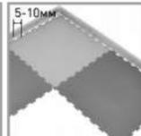
**7.** Для подгонки покрытия по размерам помещения, модули примыкающие к стене могут быть обрезаны острым **столярным ножом или электрическим лобзиком.**
