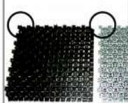
**9.** Замки покрытия спроектированы таким образом, что модули можно укладывать **со смещением друг относительно друга**, кратным расстоянию между элементами замка.
